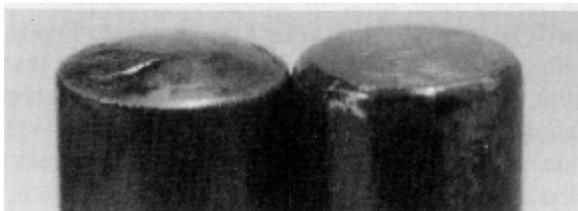
**Фотография 3-16:** Показаны заводской и модифицированный плунжеры эжектора. Я предпочитаю уменьшить радиус на кончике до плоской области, имеющей лишь небольшое
