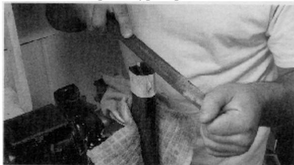
**Фотография 2-44:** Полукруглый напильник будет удобным для завершения плоских срезов на древесине. Здесь мы срезали до свежей древесины (глубже чем может проникнуть любое масло от старой обработки поверхности) в подготовке к беддингу приклада на стекло к ресиверу. См. текст и соответствующие фотографии для полноты обсуждения. (Этот конкретный приклад от рычажной винтовка Марлин, процесс будет сходным для ложи любой винтовки, состоящей из двух частей.)
