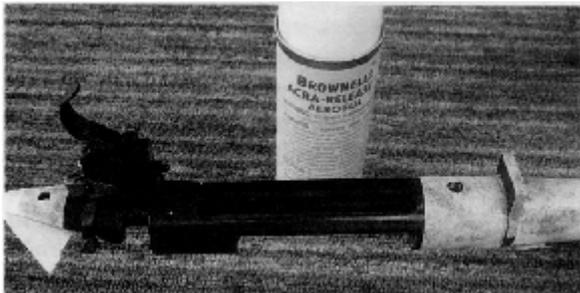
**Фотография 2-85:** Здесь мы предприняли очень критический шаг в процессе bedding на опоры. Мы уже вклеили опоры в ложе. Мы установили затворную группу поверх опор, оклеив ресивер под вершинами опор малярной лентой в несколько слоев. Это слегка подняло опоры над каналов под ресивер в ложе. Мы пропустили винты затворной группы через
