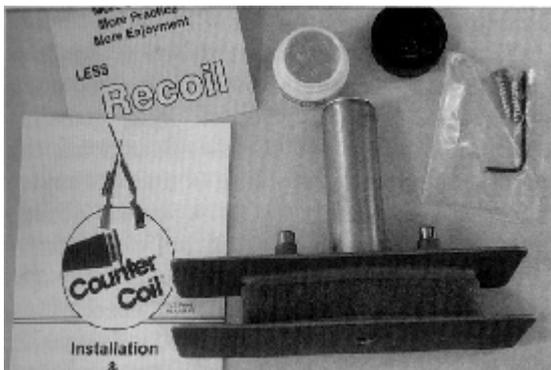
**Фотография 2-19:** Система Counter-Coil® является приспособлением активного смягчения отдачи. Регулируемый пневматический поглотитель отдачи и пружина (спрятанная в центральной трубке) работают совместно для обеспечения эффективного управления отдачей в весьма малых габаритах и массе. Выпрямление и укорочение средней ложи, необходимые для установки, ведут к практически нулевому изменению веса готовой ложи! Инструкции по
