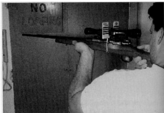
**Фотография 7-27:** Наблюдение через оптический прицел для проверки выравнивания сетки с использованием *Reticle Leveler* от *Segway Products*. Смотри текст и соответствующие фотографии для полноты обсуждения.
