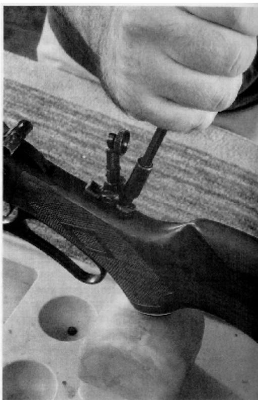
**Фотография 12-8:** Установка прицела завершает работу. Задний винт прицела заменяет стандартный винт хвостовика; передний винт базы проходит только через хвостовик.
