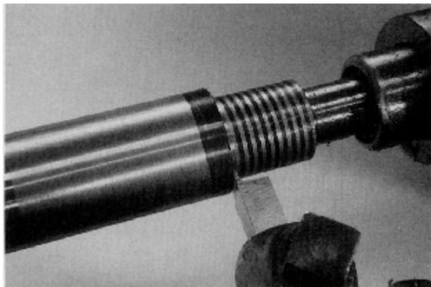
**Фотография 19-8:** Здесь г-н Константайн сделал два прохода для выполнения резьбы квадратного профиля на этом стволе Krieger, предназначенном для установки на Марлин Модели 1895 под патрон .45-70 Government. Он уже проточил на необходимую длину казенный конец ствола диаметром, соответствующим главному диаметру резьбы ствола. Обратите внимание на краску Дукет, использовавшуюся для удобства фотографирования.
