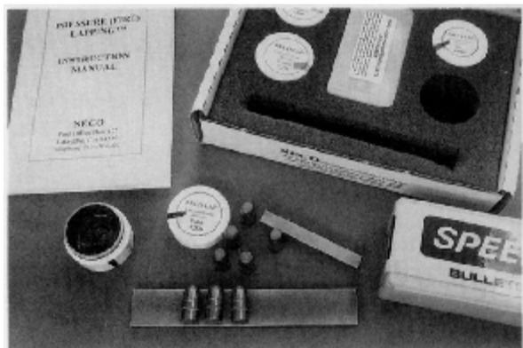
**Фотография 1-27: Здесь мы приготовились к обработке притирочным составом трех оболочечных пуль калибра .45-70 одновременно.**
