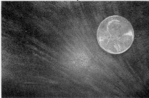
**Фотография 2-104: Крупный план наполовину узорчатой ложки из черного ореха от Fajen для помповой винтовки Ремингтон. Обратите внимание на отчетливо видную игру этой древесины. Это превосходный кусок дерева, и ребята из Fajen показали характерное усердие в выборе и распиловке этой ложки – прекрасное дерево расположено на щеке приклада, в то время как менее узорчатые и насыщенные цветом волокна на конце, прилегающем к ресиверу, этой ложки, где дерево должно быть максимально прочным.**
