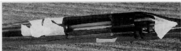
**Рисунок 2-86:** Собранная винтовка после того, как мы заполнили выемку под упор отдачи постелью из эпоксидной композиции. Обратите внимание на малярную ленту, использовавшуюся для временного удержания нижней плиты на месте, пока мы не установили и не затянули винты затворной группы на месте в отверстиях ресивера.
