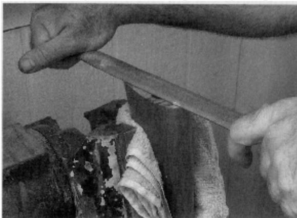
**Фотография 2-7:** *Здесь мы стачиваем напильником следы резания с приклада. Этот полукруглый драчевый напильник выполняет работу достаточно быстро. Возможны другие методы. К примеру, можно использовать ременную шлифовальную машинку. Тем не менее, будьте внимательны, старайтесь не изменить угол на поверхности этого реза, который должен быть перпендикулярен оси канала ствола (как в вертикальной, так и в горизонтальной плоскости). Смотри*
