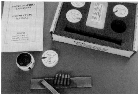
**Фотография 1-32: Пять оболочечных пуль калибра .30 после обработки их притирочным агентом 1200 зернистости. Следующий шаг – очистка пуль от избытков притирочного агента. Стрелок снаряжает самостоятельно обработанные пули в патроны с использованием стандартных рецептур зарядов, а затем выстреливает их через ствол оружия. Типичный сценарий состоит из 8 выстрелов пулями, обработанными агентом 220-й зернистости; затем примерно 10 выстрелов**
