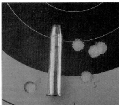
**Фотография 13-40:** Если вы постоянно видите группы вроде этой, ваша винтовка, скорее всего, имеет проблемы с беддингом. В этом случае возможной причиной является ослабленное крепление приклада к ресиверу. Смотри в тексте методы исправления этой проблемы на винтовках с отдельными ложами, использующими систему крепления приклада стяжным болтом.
