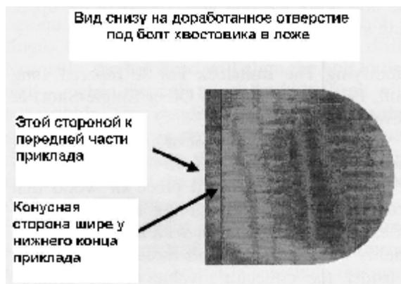
Гладкий беддинг приклада под конический болт хвостовика, винтовки со снижающимся затвором (и другие однозарядные) и рычажные винтовки:
