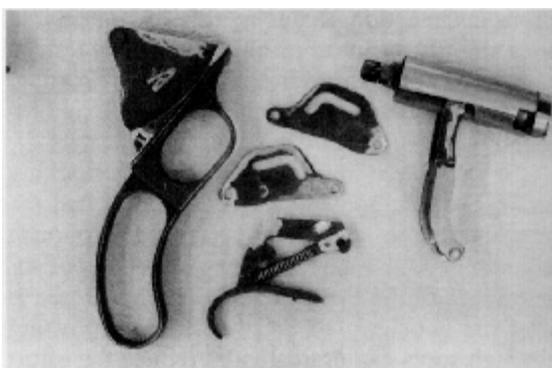
**Фотография 14-28:** Детали затворной группы Винчестера Модели 88. Обратите внимание на полировку, проведенную на этих поверхностях трения. Здесь необходимо отполировать только верхушки неровностей. Смотри фотографии 14-24/28 и соответствующий текст.
