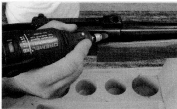
*Фотография 3-2: Инструмент Dremel, оснащенный войлочным наконечником, обработанным красным полировальным компаундом, используется здесь для полировки канала окна выброса гильз в передней части окна ствольной коробки помповой винтовки Ремингтон. Внутреннюю поверхность этого окна и канала можно слегка удлинить, не*
