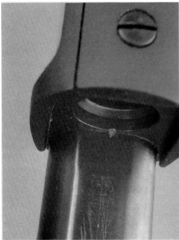
**Фотография 1-41:** Установочные метки на винтовке Марлин. Эти метки ставятся как на стволе, так и на ресивере. Смотри текст и соответствующие фотографии.
