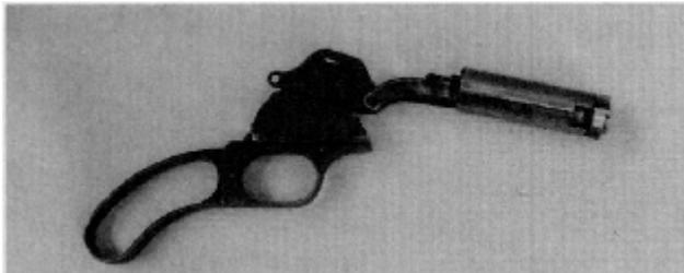
**Фотография 14-24:** Детали затворной группы Винчестера Модели 88. На этом виде показан затвор, шарнирные плечи и рычаг спусковой скобы примерно в той же самой ориентации, как они располагаются в собранной винтовке и запертом затворе.
