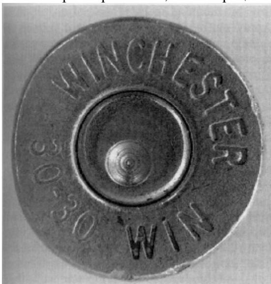
*Фотография 5-8: Гильза, отстрелянная из помповой винтовки Сведж Модели 170. Здесь очевидны три вещи: Во-первых, боек бьет далеко от центра; во-вторых, удар бойка не очень сильный (неглубокая вмятина); в-третьих, носик бойка несколько великоват. При аккуратном выполнении работы, все три проблемы можно легко исправить. Смотри текст, фотографии и подписи под ними.*
