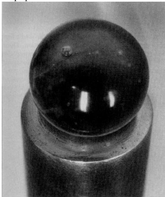
**Фотография 1-4:** Это низкотехнологичный и старый, но эффективный метод исправления дульного среза ствола. Здесь мы просто кладем обычный стеклянный шар на дульный срез. На область контакта наносим притирочную пасту с зернистостью 600, затем несколько минут вращаем шар рукой (иногда это можно делать ладонью руки), в результате получаем прекрасно выполненную работу. Смотрите соответствующие фотографии и текст.
