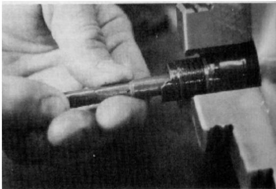
**Фотография 8-12:** Крупный план при токарном станке, выключенном для удобства фотографирования. Операция полировки патронника. Обратите внимание на изоленку, обернутую вокруг ствола. Это предохраняет ствол от косметических повреждений в те моменты, когда оружейник зажимает губки патрона. Здесь оружейник извлекает полировальный инструмент из хорошо смазанного патронника. Полировка не является
