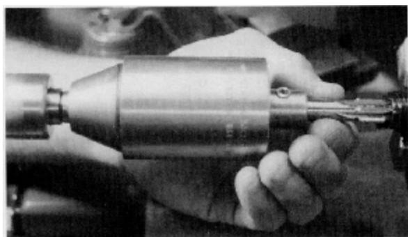
**Фотография 8-8:** Работа почти закончена! Здесь наш оружейник аккуратно извлекает развертку после окончания углубления патронника. (В этом случае мы могли наблюдать правильный зеркальный зазор, основываясь на том, что рантовый буртик развертки слегка коснулся существующего буртика в задней части ствола, так как это работа по переделке патронника под патрон с
