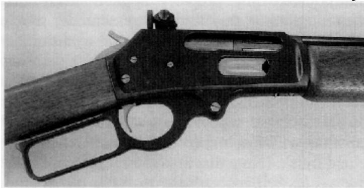
**Фотография 19-22:** Это Марлин Модели 1895 (.45-70 Government) был доработан - установлен дополнительный диоптрический прицел на ресивер и нанесено специальное покрытие на металл. Ресивер, рычаг спусковой скобы, ствол и трубка магазина были покрыты суперпрочным и предохраняющим запеченным
