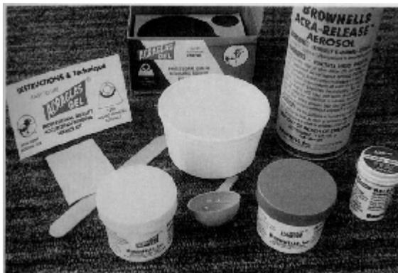
**Фотография 2-81: Набор Brownell's Acraglas Gel и их аэрозольный разделитель Acra-Release. Эти продукты позволяют выполнить быстрый и простой гласс беддинг затворной группы в ложе. Не экономьте разделитель. Ошибка с нанесением его на один квадратный дюйм чистого металла может привести к возникновению склейки, которая сможет выдержать несколько тысяч фунтов силы! На практике вы не сможете разделить две детали,**
