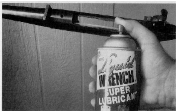
*Фотография 1-47: Здесь мы наносим пенетрационное масло на резьбу ствола-ресивера. Пластиковая трубочка направляет пенетрант в нужную область. Полное описание смотри в тексте и подписях под соответствующими фотографиями. В этом случае мы обнаружили, что производитель приклеил ствол к ресиверу похожей на эпоксидный клей субстанцией, нанеся ее на витки резьбы. Мы были вынуждены*
