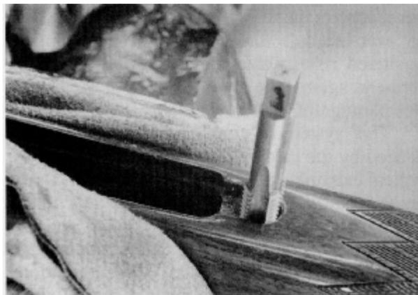
Для предотвращения этого прослабления, рассверлите направленную к каналу под ствол сторону существующего отверстия. Используйте спиральное сверло для сверления стали диаметром в полдюйма для рассверливания этого отверстия. Сверление производите на глубину в четверть дюйма (от верха).
