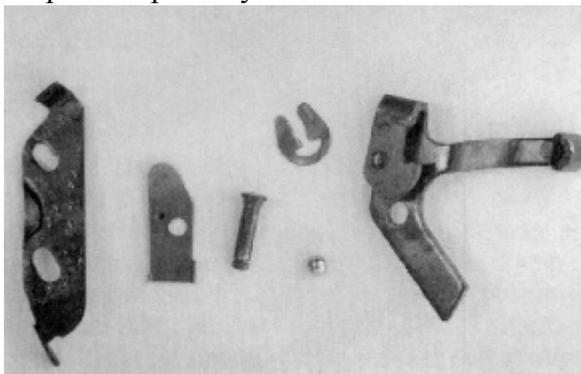
**Фотография 4-4:** детали механизмов затворной задержки и предохранителя винтовки с поворотным затвором ремингтон Модели 700 в исполнении для левши. Отделение изображенной «С»-образной стопорной шайбы от изображенной оси освобождает шесть деталей. При установке сменных спусковых механизмов на Ремингтонах необходимо повторно использовать эти детали. Смотри текст.
