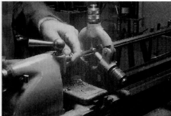
*Фотография 19-10: Это один из методов выполнения патронника. Здесь оружейник (в McBros Rifle Company) использует люнет для центрировки ствола. Обратите внимание на развертку и стружки. Существует несколько методов выравнивания ствола и развертки, у вашего оружейника наверняка есть свой, излюбленный. Все методы имеют одну общую черту: все они требуют, чтобы настройка и работа проводилась опытным мастером,*
