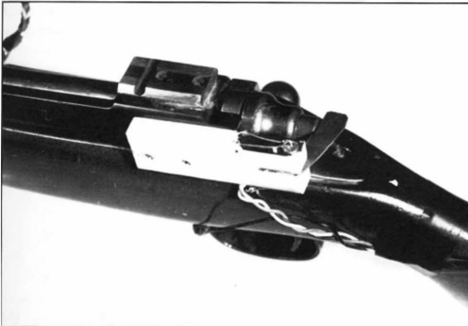
Рисунок 2-14 – Фотография ключа для старта осциллографа, срабатывание которого начинает процесс измерения.
