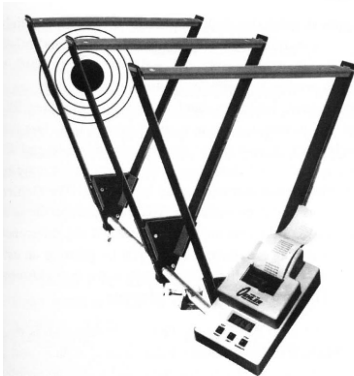
Рисунок 10-23 – Фотография новейшего современного хронографа (Oehler 35P) с тремя оптическими воротами. Этот хронограф использует для вычислений технологию микросхем и имеет встроенный принтер для записи всех данных. Он измеряет скорость с точностью 2-3 фт/сек при 3000 фт/сек. Оптические ворота куда более совершенны, чем другие типы триггеров.
