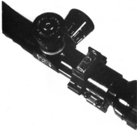
Рисунок 10-25 – Противонаклонное уровневое устройство, смонтированное на трубе 36х целевого прицела Vausch and Lomb прямо перед окуляром. Оно эффективно в минимизации наклона винтовки.
