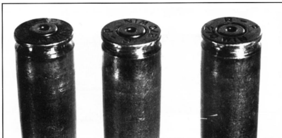
Рисунок 4-15 – Фотография стреляных 270 Винчестер гильз, демонстрирующая выход капсюля в результате увеличенного зеркального зазора в 15, 8 и 0 миллидюймов слева направо. Эксперимент проведен на специальных усиленных и обезжиренных гильзах.
