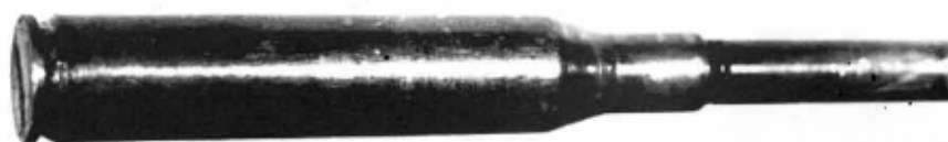
Рисунок 2-8- Фотография модифицированной гильзы 270 Винчестер с присоединенной стальной трубкой с внешним диаметром 0,25 дюйма для измерения давления в процессе калибровки. Стальная трубка проходит через весь ствол и выходит из его дульной части, где присоединяется к гидравлическому цилиндру, показанному на Рисунке 2-10.
