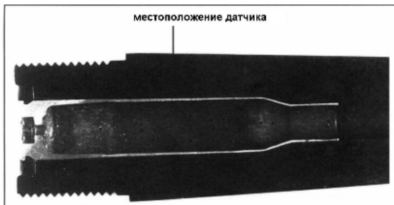
Рисунок 2-7- Разрез патронника и гильзы калибра
