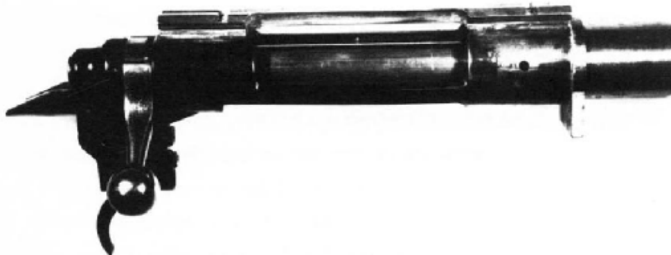
Рисунок 5-4 – Фотография стальной мостообразной базы для прицела на винтовочном ресивере, использованного для решения проблемы дифференциальной нагрузки между кольцами прицела.
