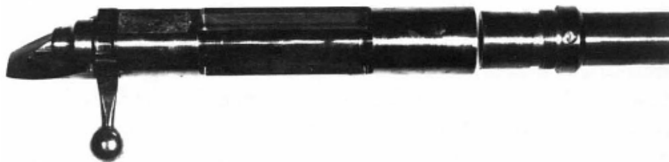
Рисунок 6-12 – Фотография затворной группы, показывающая разобранное соединение ствола, которое не чувствительно к температуре и другим проблемам соединения ствола. Эта конструкция соответствует Рисунку 6-11.
