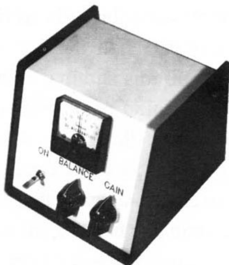
Рисунок 10-17 – Фотография индикатора на стрелковом станке, предназначенного для электронных датчиков ветра. Если ветер дует справа, игла измерителя движется вправо, и наоборот для ветра слева. Стрелять нужно тогда, когда игла находится в одном и том же месте.
