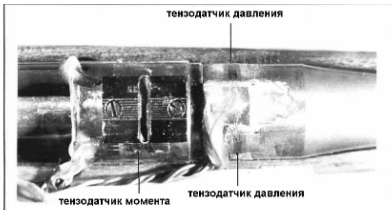
Рисунок 2-2- Экспериментальная винтовка смонтирована на станке.
