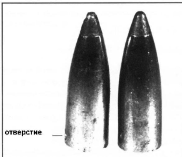
Рисунок 7-9 – Пуля слева имеет подточное на угол 2 градуса донце по сравнению с нормальной пулей справа. Маленькое отверстие в левой части донца модифицированной пули компенсирует асимметрию масс, возникшую в результате скашивания донца. Донца обеих пуль покоятся на стеклянной плите. Заметьте, что модифицированная пуля слева прислонилась к нормальной пуле справа.
