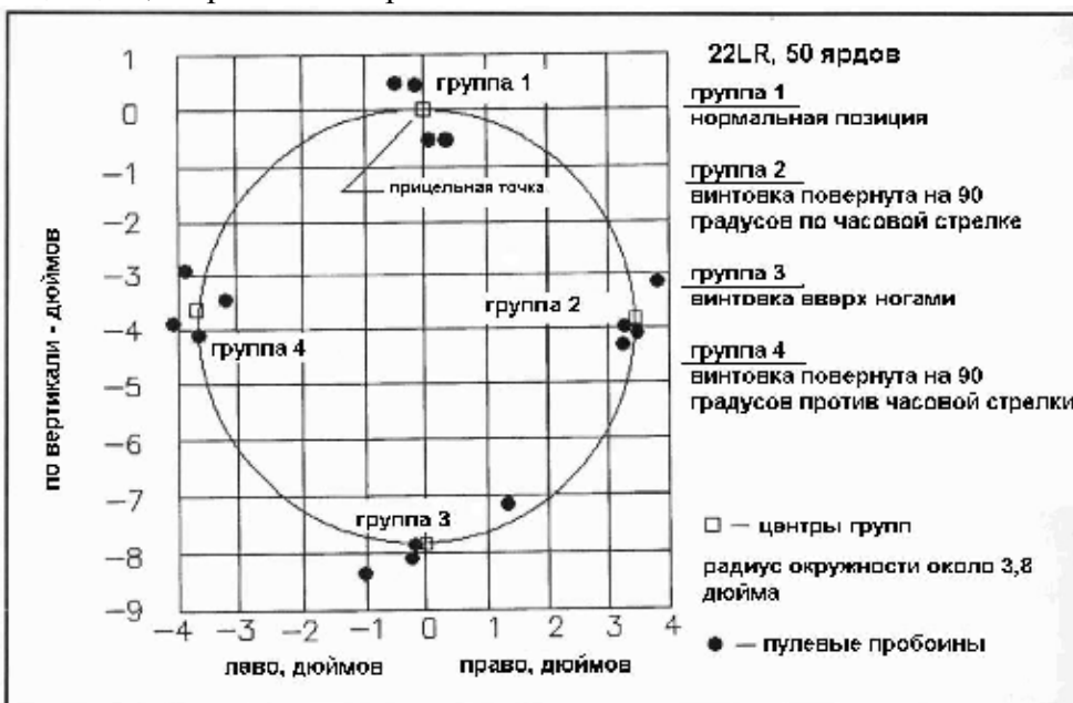
Рисунок 10-24 – Компьютерная распечатка мишени, показывающая четыре группы, выстрелянные из винтовки в вертикальной позиции, наклоненной на 90 градусов по часовой стрелке, вверх ногами, наклоненной на 90 градусов против часовой стрелки.
