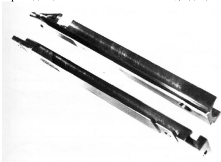
Рисунок 4-8 – Фотография изолятора отдачи скольжения по направляющей. В результате проверки выяснено, что он уступает Изолятору Отдачи с гибкими элементами.
