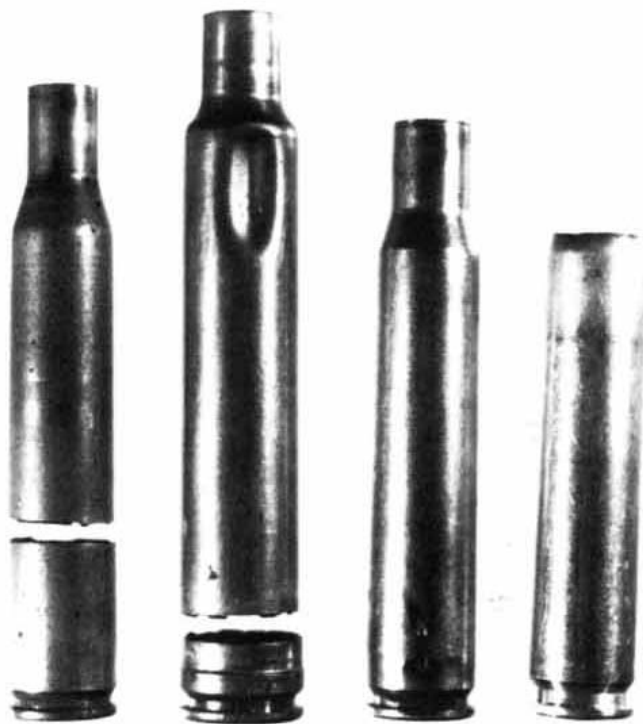
Рисунок 2-26 – фотография четырех гильз, демонстрирующая различные формы повреждений. Отделение донной части показано на двух крайних слева случаях. Осевая трещина около донной части на третьем слева случае. Крайняя справа гильза получена после выстрела патроном 7мм-08 из патронника калибра 280 Ремингтон.
