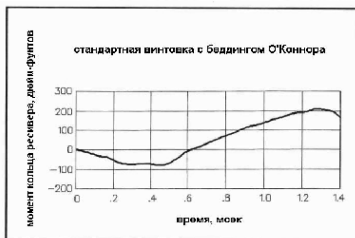
Рисунок 4-36 – Измеренный момент переднего кольца ресивера с произведенным беддингом О'Коннора, где показано уменьшение момента на 50% по сравнению со стандартной винтовкой. Смотри Рисунок 4-3 для сравнения.
