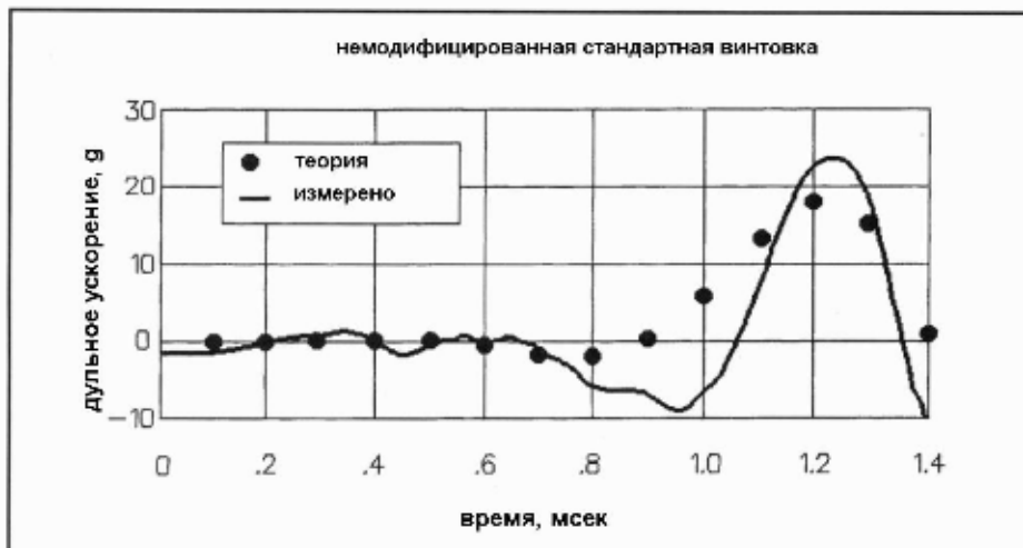
Рисунок 4-30 - Сравнение измеренного экспериментального вертикального дульного ускорения для немодифицированной стандартной винтовки в вертикальной плоскости с ускорением, рассчитанным при помощи программы вибрации ствола.
