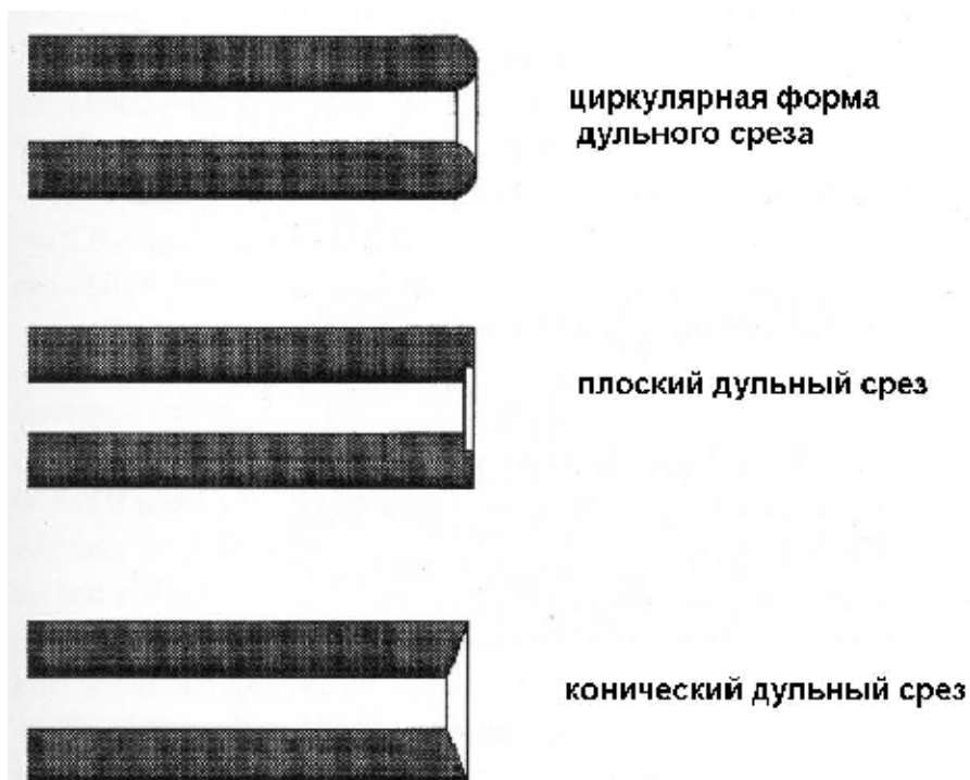
Рисунок 7-26 – Разные виды формирования дульного среза.
