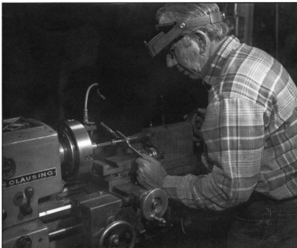
Рисунок 3-3- Фотография, демонстрирующая изготовление патронника.
