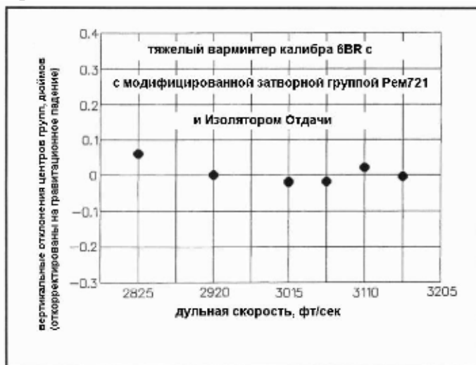
Рисунок 4-42 – График вертикального расположения центров групп для различных навесок пороха и начальных скоростей для винтовки на модифицированном ресивере 721 с Изолятором Отдачи и тяжелым варминт стволом калибра 6 мм BR. Гравитационная поправка устранена.
