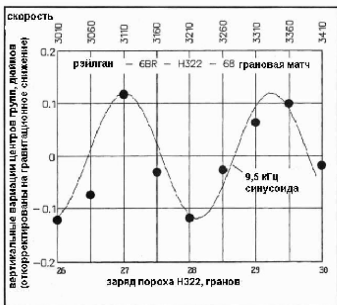
Рисунок 4-39 – График, демонстрирующий вертикальные смещения средних точек попадания (СТП) групп на 100 ярдов, выстреленных из рэйлгана, в зависимости от различных навесок пороха и дульных скоростей в сравнении с синусоидой с частотой 9,5 кГц. Частота 9,5 кГц наблюдалась в измерении вибрации ствола. Точки попадания откорректированы на разницу в падении от силы тяжести.
