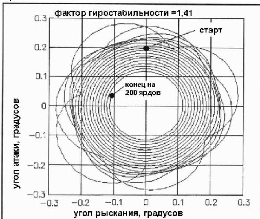
Рисунок 10-3 – Распечатка, показывающая конусообразное движение пули с ГС=1,41 , выпущенной под углом атаки в 0,2 градуса. Этот ГС типичен для бмм 68 грановой пули.
