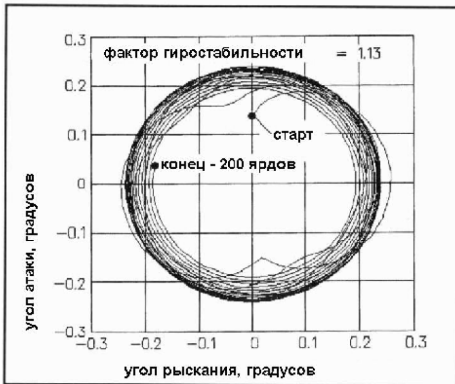
Рисунок 10-4 – Распечатка, показывающая конусообразное движение для пули, выпущенной под углом атаки в 0,13 градуса с очень низким ГС = 1,13. вы можете видеть, как конусообразное движение трудно затухает на протяжении всех 200 ярдов дистанции по сравнению с тремя предыдущими случаями. Также заметьте, что угол атаки быстро вырастает до угла в 0,25 градуса. Такое движение типично для всех пуль с низким ГС и нормальной оживальной формой носика.
