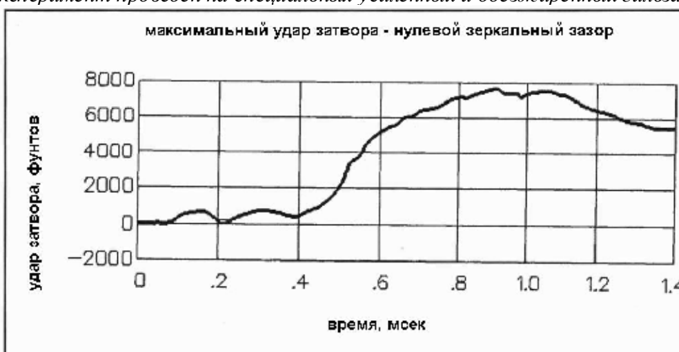
Рисунок 4-16 – Экспериментальные данные измеренного максимального удара затвора, получающегося в результате нулевого зеркального зазора или смазанной гильзы.
