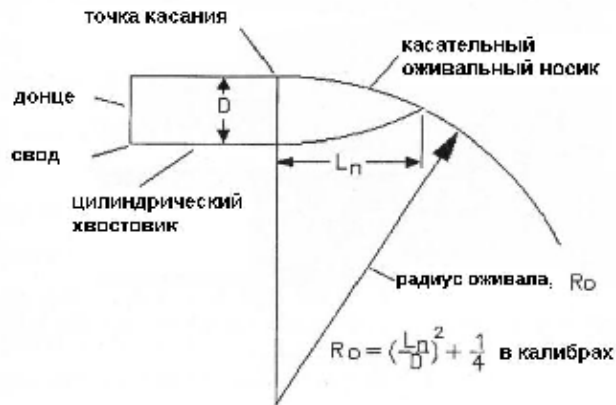
Рисунок 7-5 – Рисунок, демонстрирующий геометрию оживально-касательной пули.
