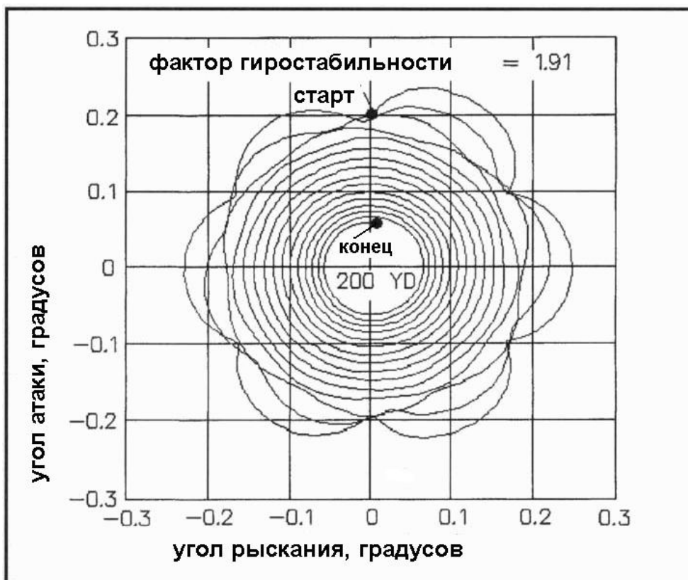
Рисунок 10-2 – Распечатка, показывающая угловое движение пули при ГС=1,91 , выпущенной под начальным углом атаки 0,2 градуса. Заметьте, что частоты прецессии меньше, чем на предыдущем графике, где ГС был 2,98 , и коническое движение держится дольше до затухания.
