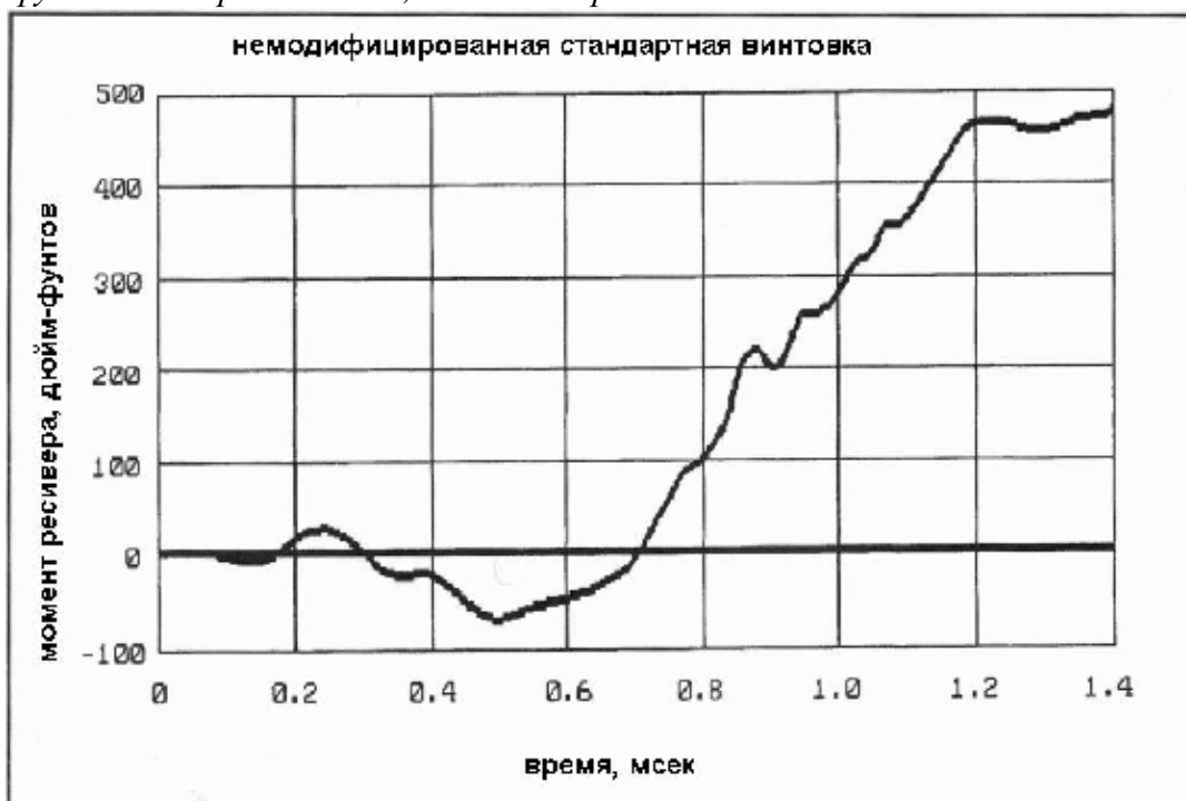
Рисунок 4-3 - Экспериментальный момент кольца ресивера на стандартной не модифицированной винтовке. Представлен средний случай
