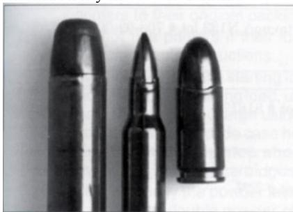
Рис. 6-20. Смятое дульце гильзы является достаточной причиной для отбраковки переснаряженного патрона.
