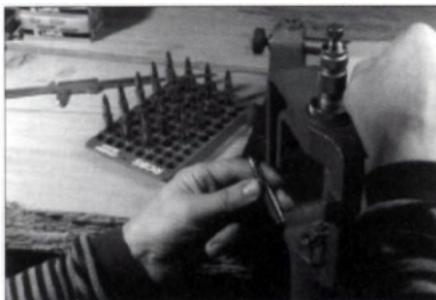
Если пуля подлежит кримпованию, она должна иметь канавку, именуемую канелюрой. Губки дульца гильзы должны обжиматься в эту канавку, что также определяет глубину посадки пули.
