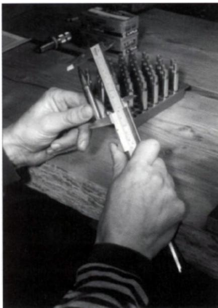
Рис. 6-16. Снаряженные патроны проверяются на правильность ОДП.
