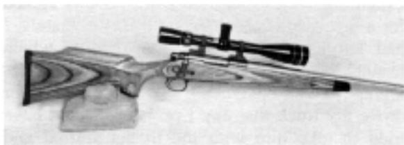
*Штучная винтовка автора .221 Fireball весит в пределах 8.8 фунтов и собрана она на затворной группе Remington со стволом Lilja контур номер 6 длиной 24<sup>2</sup> с шагом нарезов 15<sup>2</sup>.*
