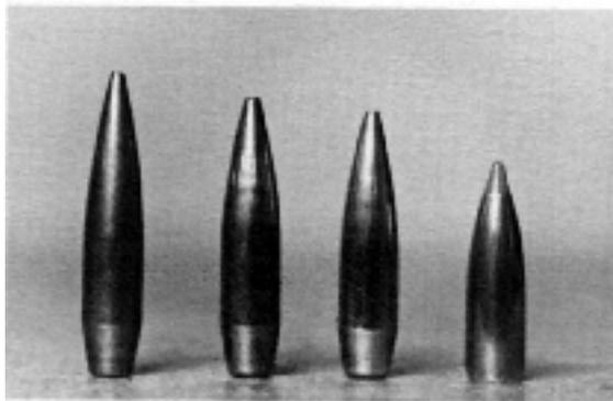
*В попытках преодолеть ветер многие фаны .22 калибра рассчитывают на тяжелые пули. Пули JLK VLD .22 калибра слева направо: 80 гран, 75 гран, 70 гран и 55-грановая Nosler Ballistic Tip для сравнения.*
